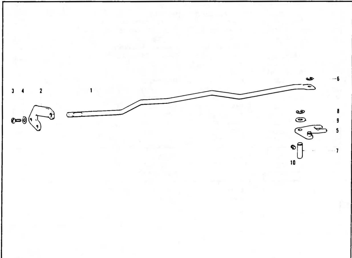
P. 糸払い関係/Thread wiper mechanism/Fadenwischvorrichtung
