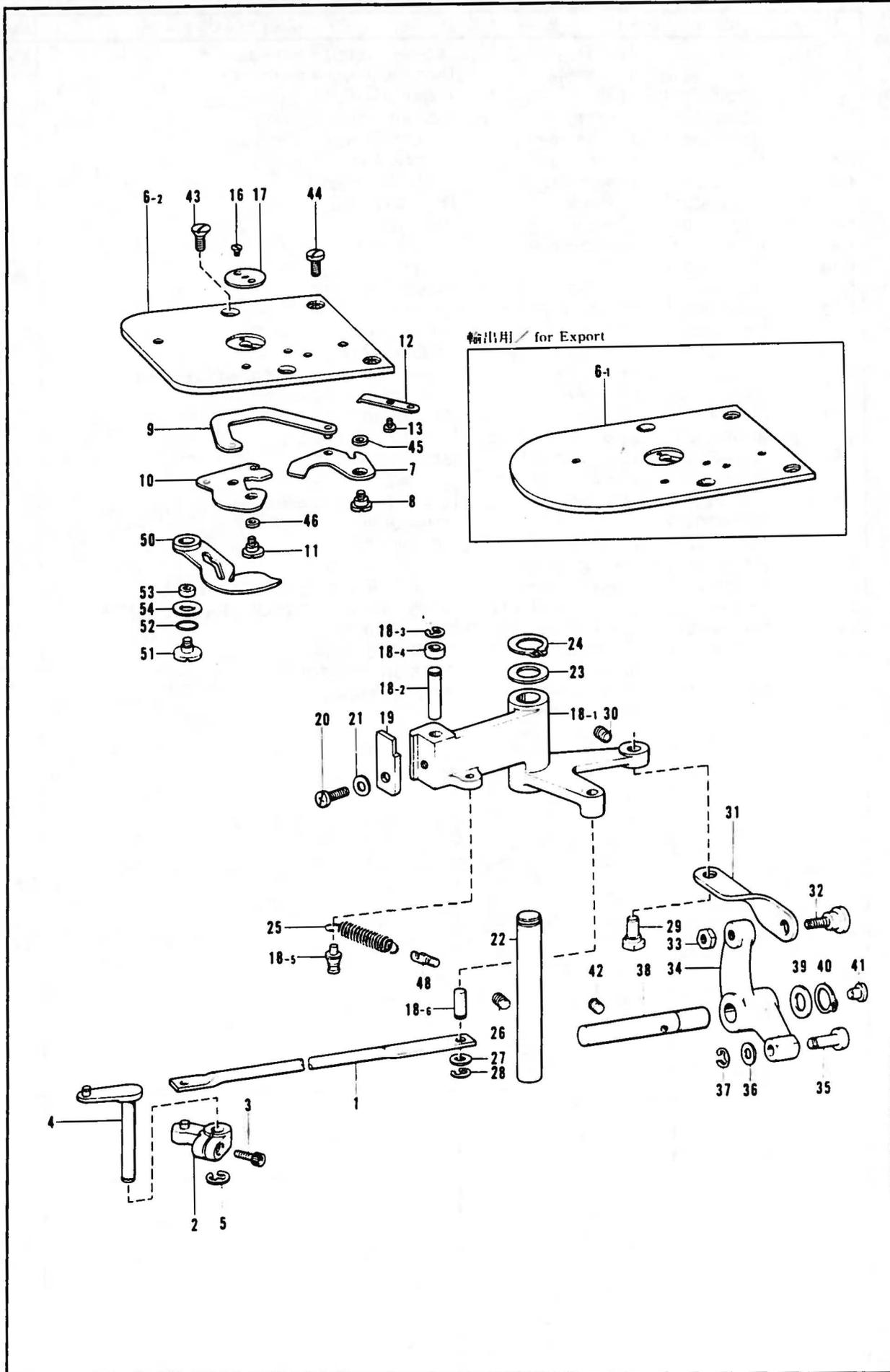
N. 糸切り関係/Thread trimmer mechanism/Fadenabschneidevorrichtung
