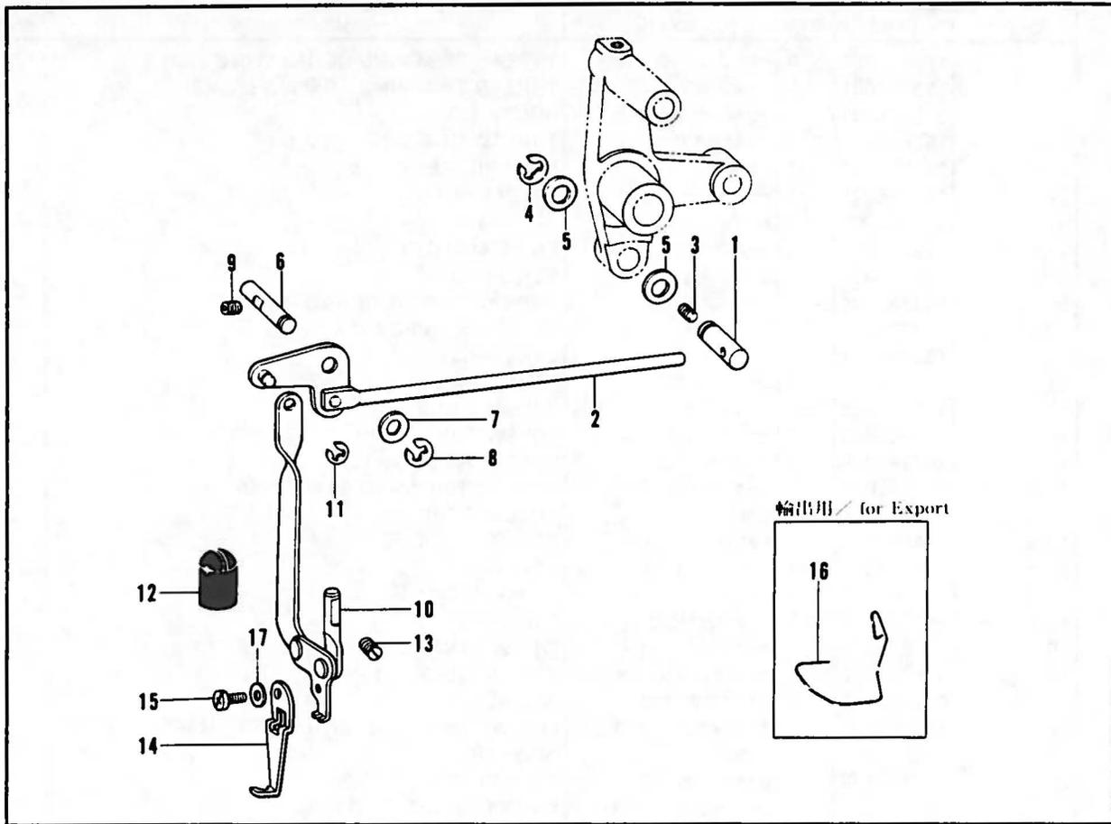
Q. 糸締メ関係 / Thread nipper mechanism / Fadenspannvorrichtung
