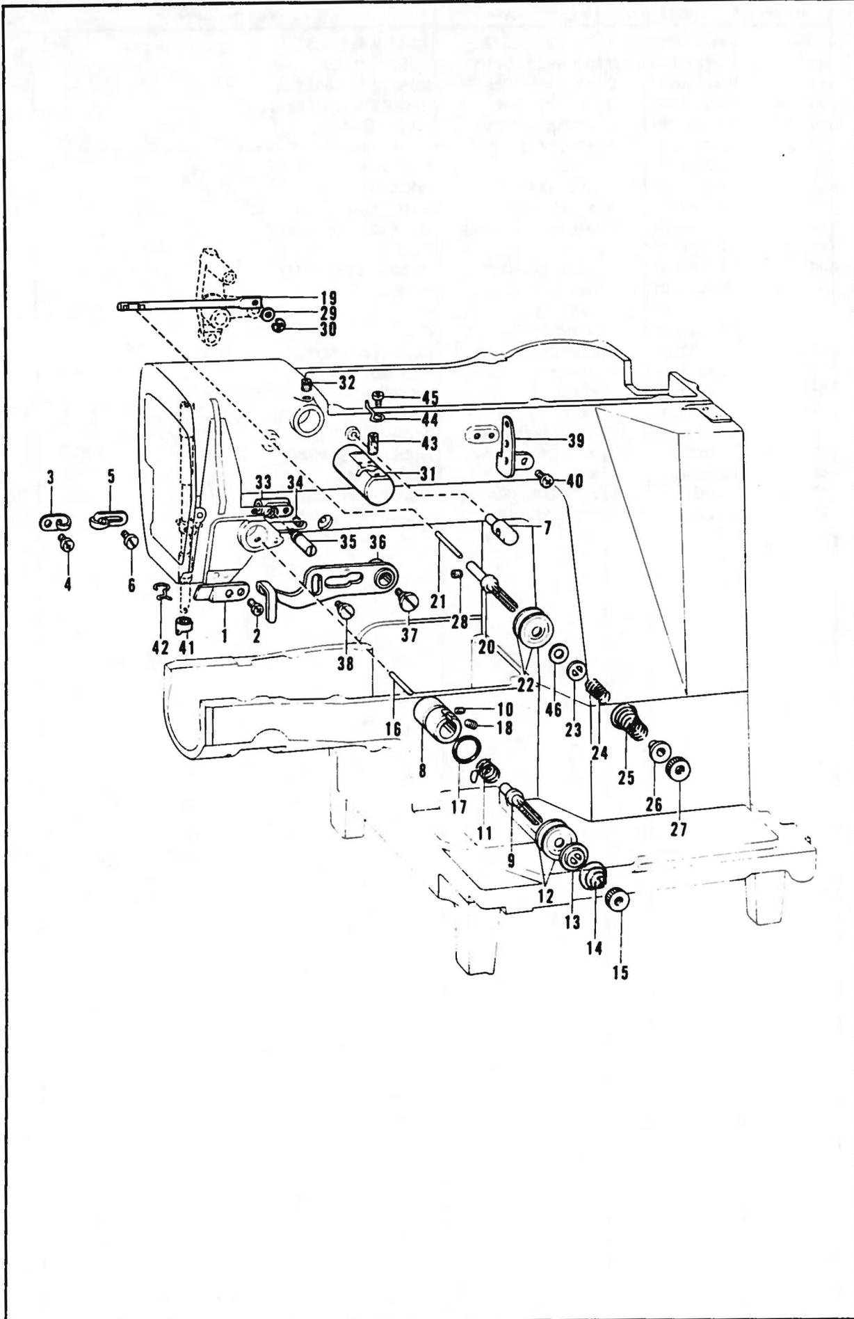
L. 糸通シ関係 / Threading mechanism / Fadenführungsrichtung
