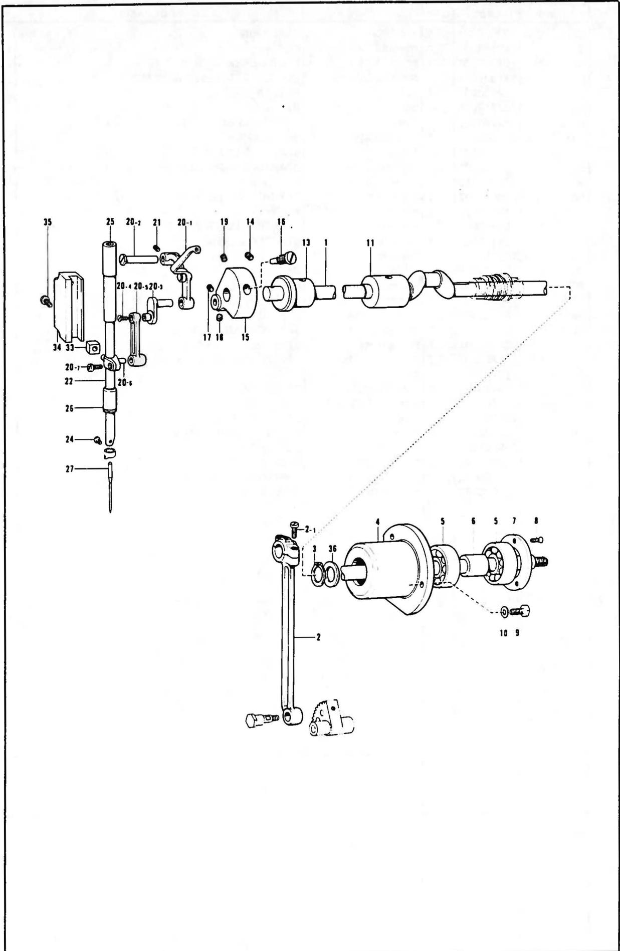
C. 上軸・針棒関係/Upper shaft and needle bar mechanism/Obere Welle und Nadelstange/
