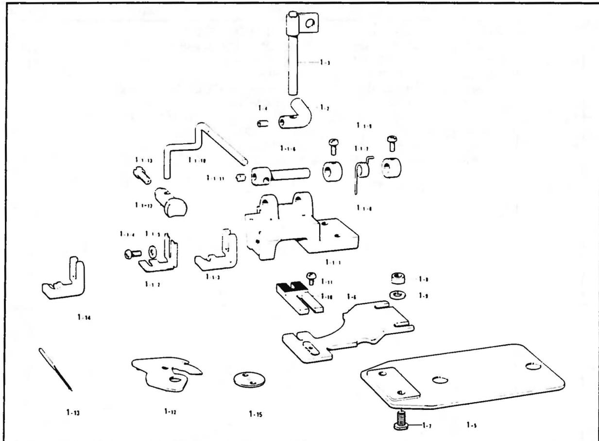
R. 動車・遊車関係/Drive pulley and idler pulley mechanism/Antriebsriemenscheibe und Riemenscheibe
