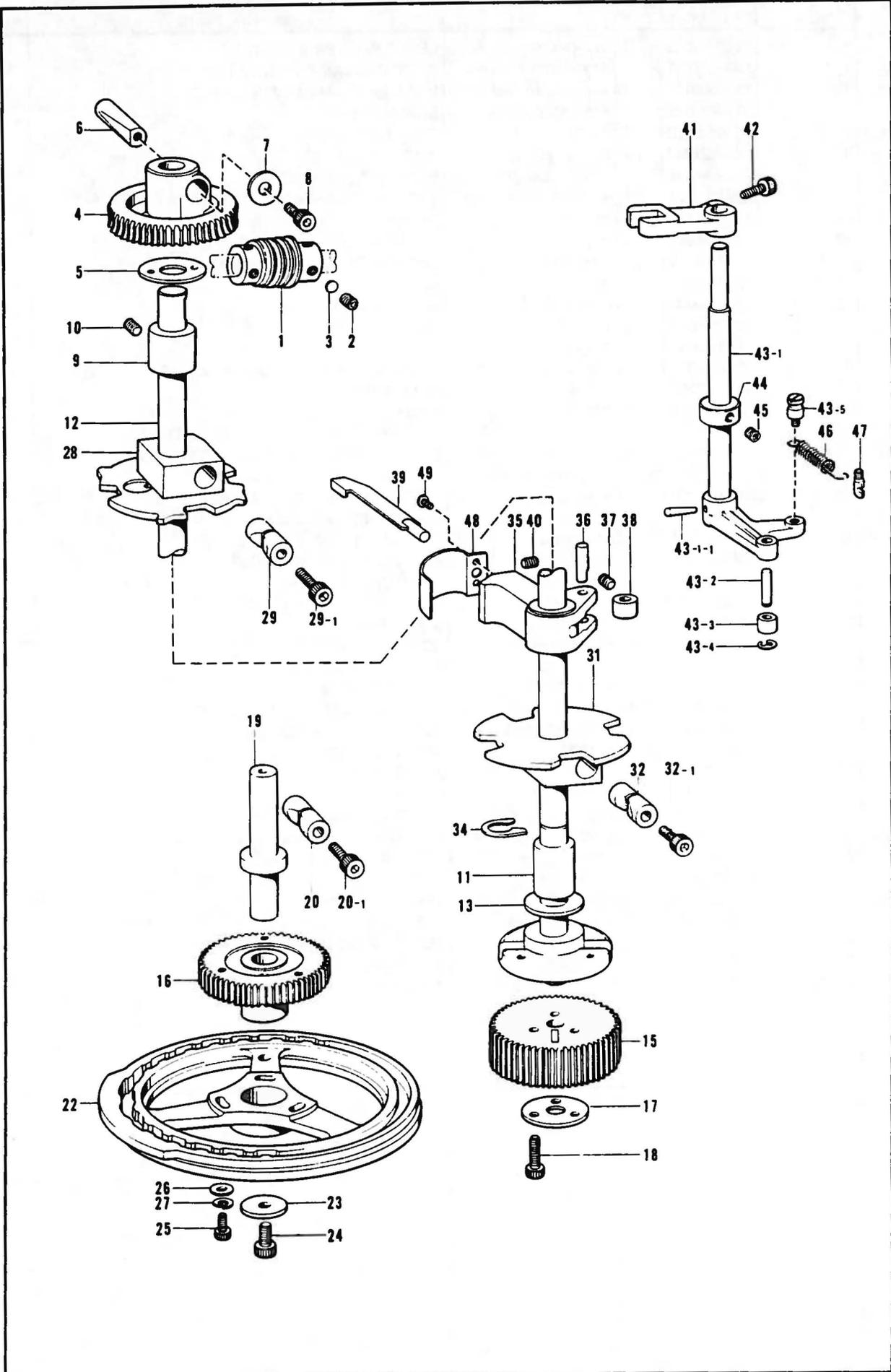
H. カム伝導関係/Feed cam mechanism/Vertikale Welle/
