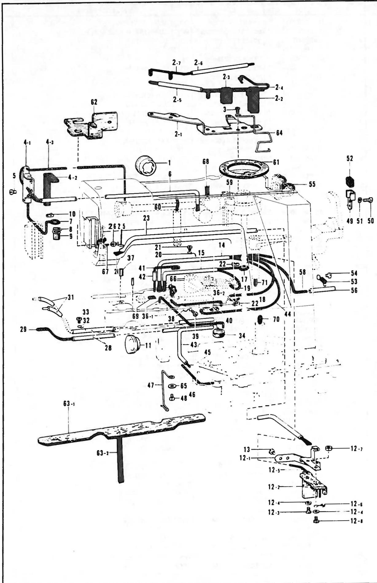
K. 給油・潤滑関係/Lubrication / Schmierung
