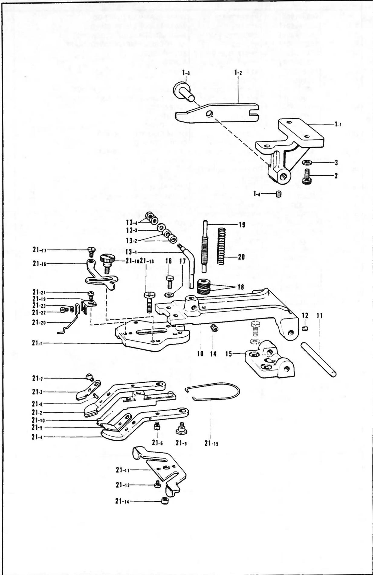
G. ボタンツマミ作動関係/ Button clamp mechanism / Knopfhaltevorrichtung /
