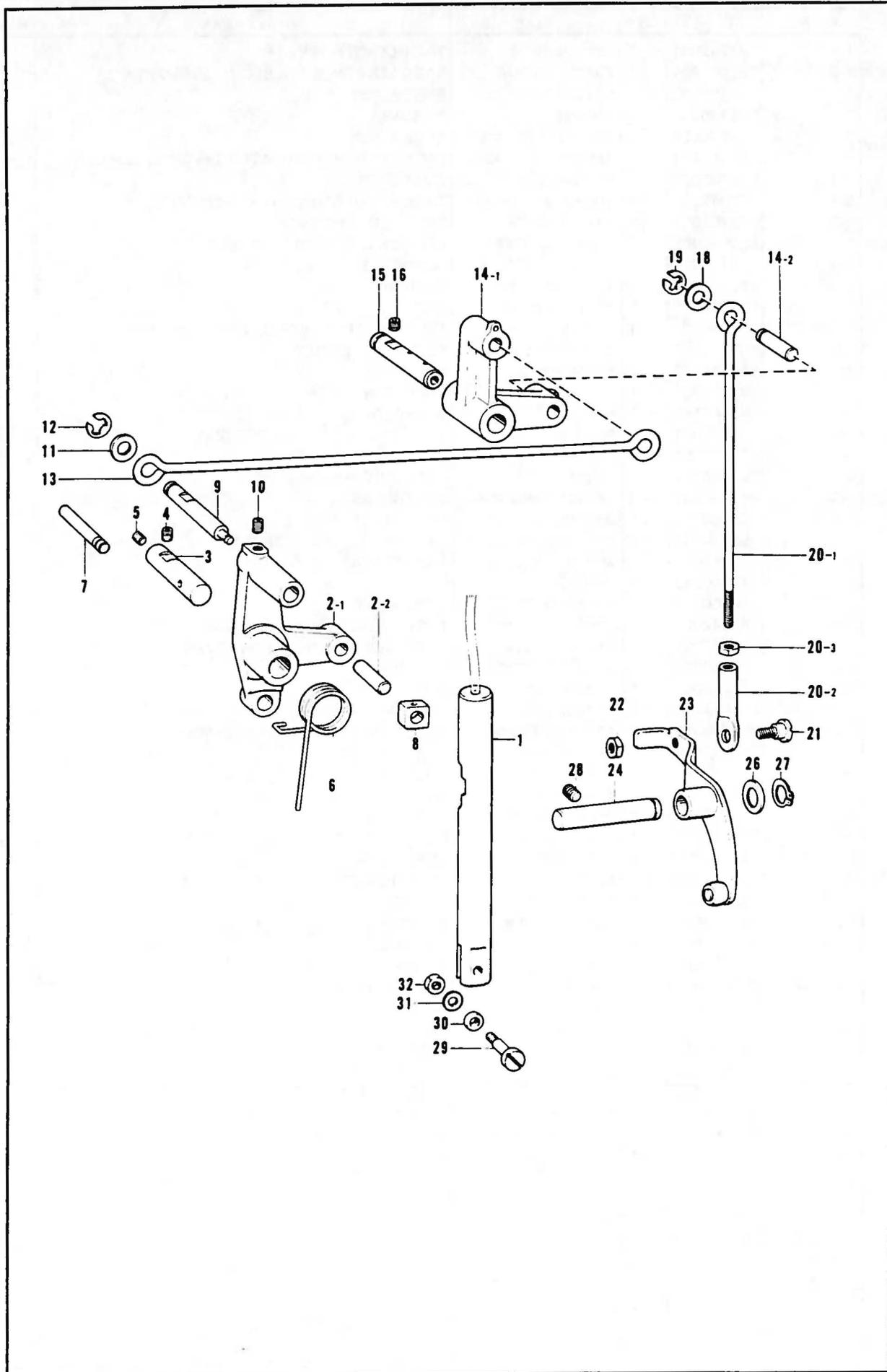
F. 押工上げ関係/Work clamp lifter mechanism/Stoffhalterhebevorrichtung/
